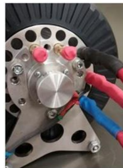
Emrax 188 avec câbles d'alimentation
