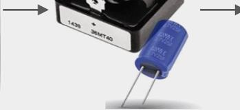
**Pont de diodes + supercondensateurs**
