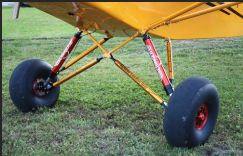
Amortisseur de train: Piper PA 19 Amortissement = 4 m/s
