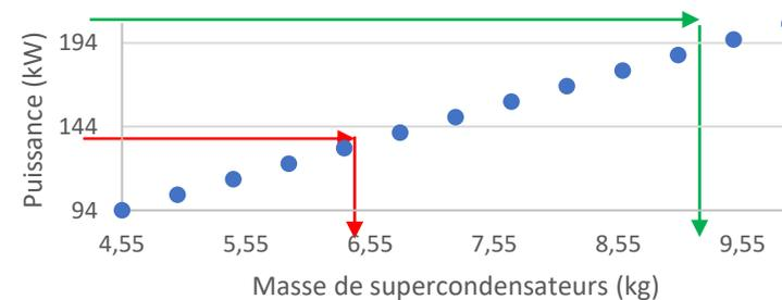
Pour décollage **140kW** et masse supercondensateurs : **4,61 kg** sans gearbox et **6,79 kg** avec gearbox
