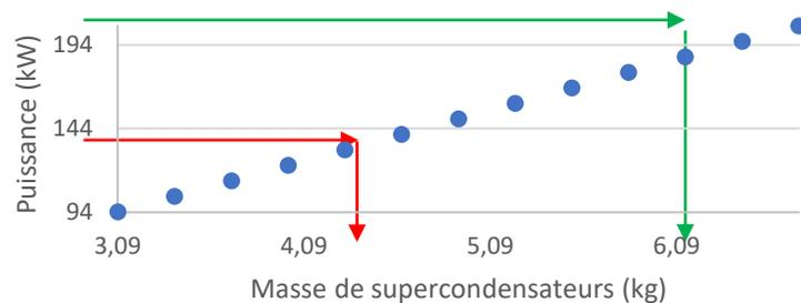
Puissance nécessaire pour faire décoller le Mini Bee **avec gearbox** en fonction de la masse de supercondensateurs
