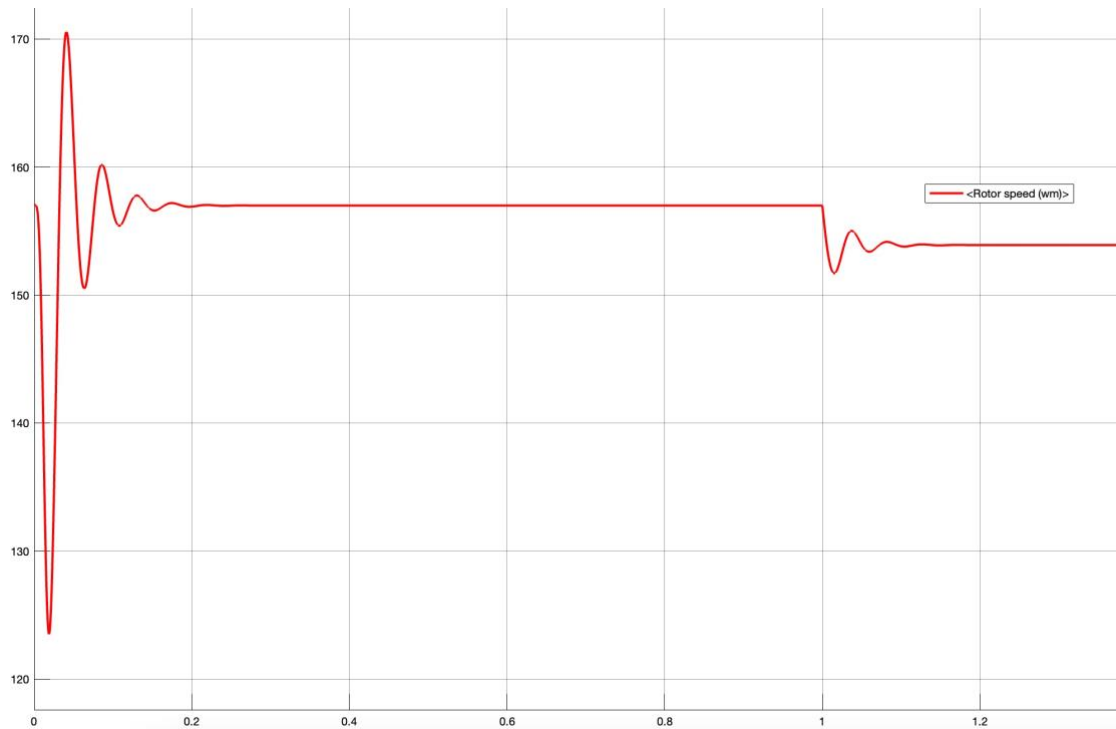
Figure 18 : Réponse du moteur au scenario 1 : Vitesse de rotation ( \text{rad}\cdot\text{s}^{-1} ) en fonction du temps (s)
