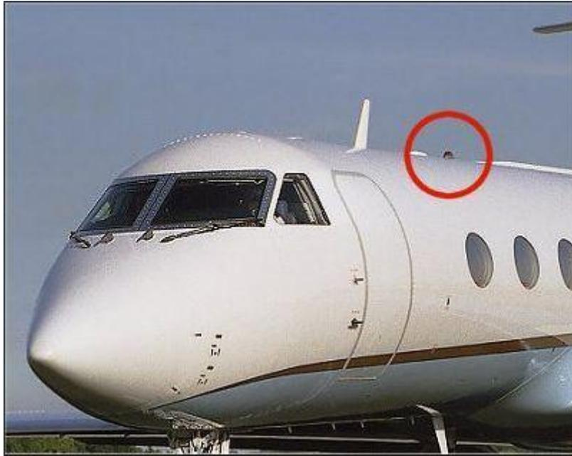
Figure 4 : Feux anticollision avion
