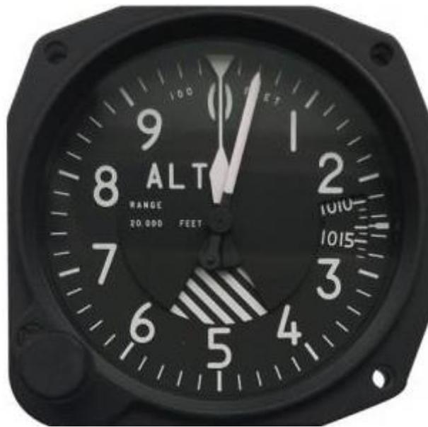
Figure 6 : Altimètre conventionnel
