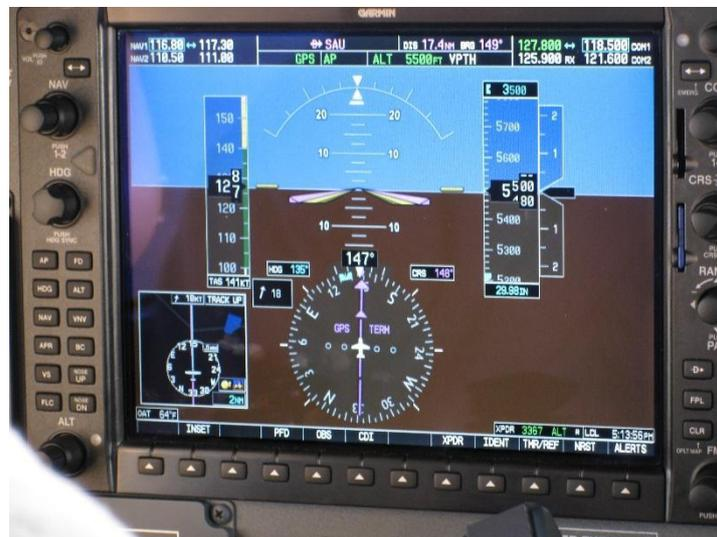
Figure 3 : Exemple d'EFIS (ici il s'agit d'un PFD)
