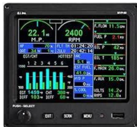
Figure 1 : affichage paramètres moteur
